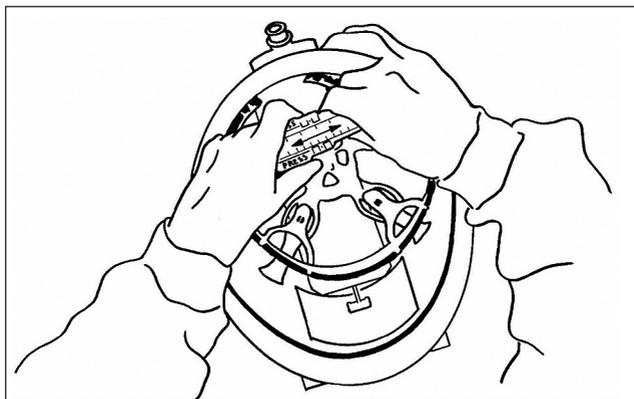
Рис. 1. Регулировка наголовника
