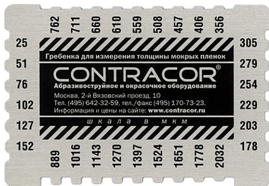
Гребенка измеряет толщину неотвердевших лакокрасочных покрытий на плоских изделиях. Диапазон измерения 25 - 2032 мкм.
