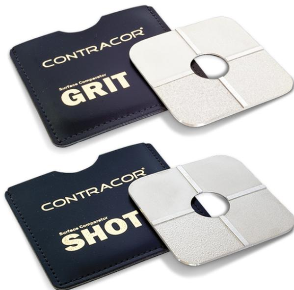
Прецизионные никелевые эталоны сравнения для оценки шероховатости поверхности после пескоструйной очистки. Соответствуют стандарту ISO 8503-1 для проведения оценки шероховатости после пескоструйной очистки колотой или литой дробью.
