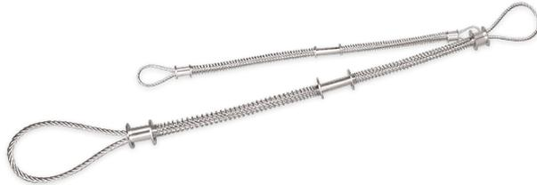
Страховочный тросик Contracor® используется для абразивоструйных рукавов на случай самопроизвольного разъединения шланговых сцеплений. Страховочный тросик освобождает сцепления от нагрузки связанной с весом рукавов и уменьшает вероятность самопроизвольного разъединения сцеплений. Кроме того, страховочный тросик удерживает рукава, находящиеся под давлением, от хаотичного движения в случае самопроизвольного разъединения сцеплений.
